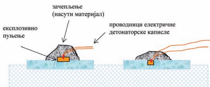
Начин израде отвора у леду употребом мањих експлозивних спољних пуњења постављањем на лед или у израђена удубљења
